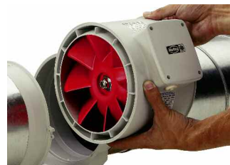
Obrázek 2 Upevnění těla ventilátoru na klipsy umožňuje kdykoliv jednotku vyjmout pro potřeby čištění nebo revize
